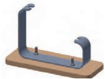
شکل ۳۹-۵. متصل کردن قطعه‌ها با پیچ و مهره
