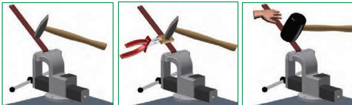
پ) خم کاری با چکش فلزی
