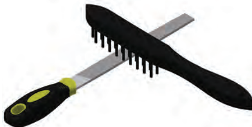
شکل ۱۷-۵. تمیز کردن سوهان با برس سیمی
